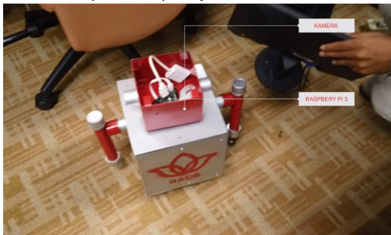
Gambar 12. Alat Pendeteksi Hama Rosella Pada Robot RAOS
