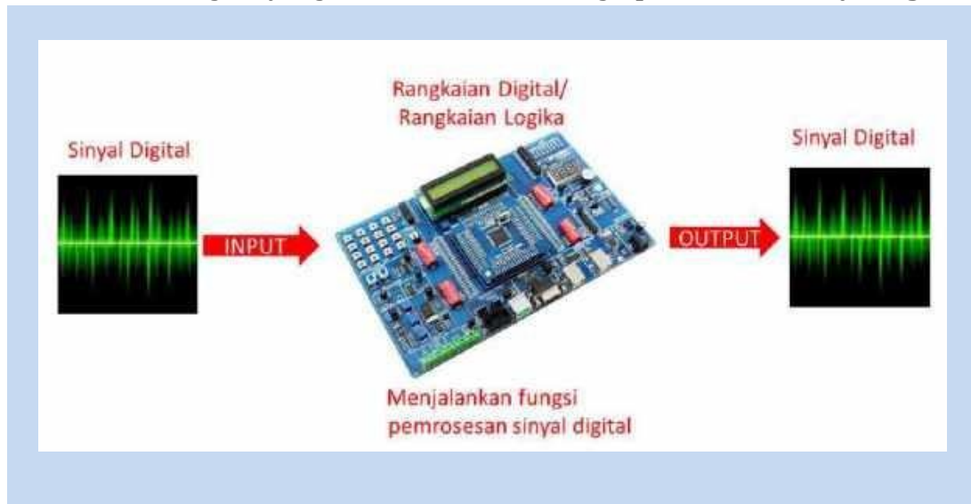
Gambar 1. Penjelasan pengertian rangkaian digital/logika
